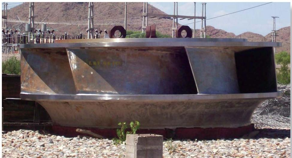
Vista del rodete de la turbina Francis, capaz de trabajar como turbina y como bomba para elevación de agua.
