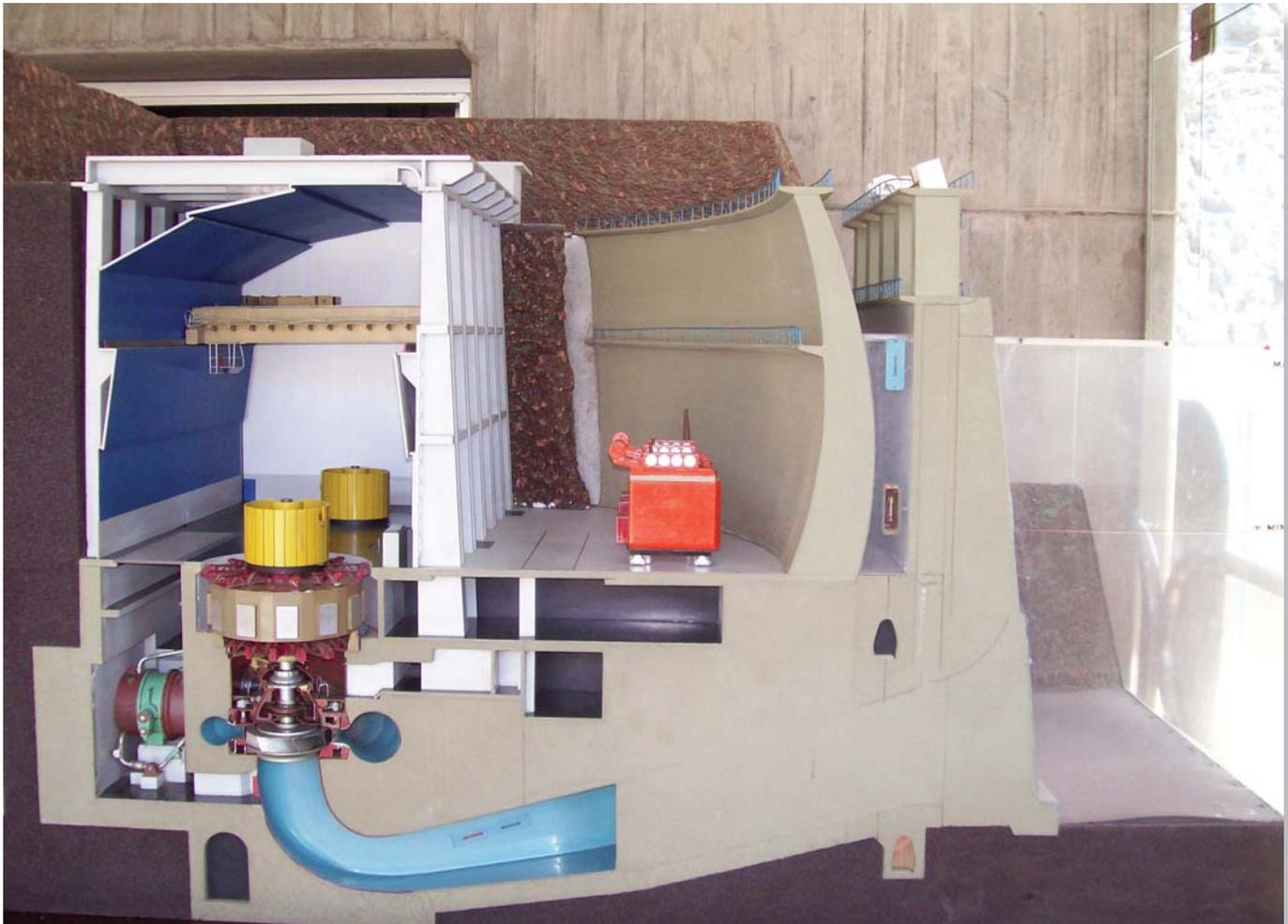
Vista de la maqueta del complejo. Puede apreciarse la válvula mariposa, la cámara espiral, la turbina, el escudo de protección y la estructura para las compuertas que cierran los conductos de restitución al río Diamante.
