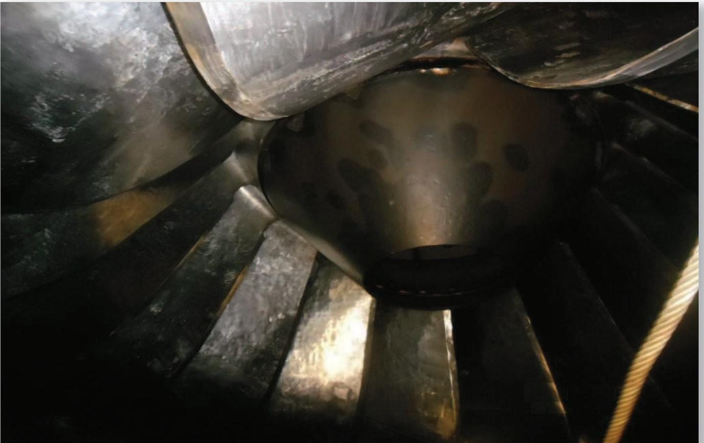
Vista del rotor de la turbina francis, se pueden apreciar los álabes y el cono de salida.
