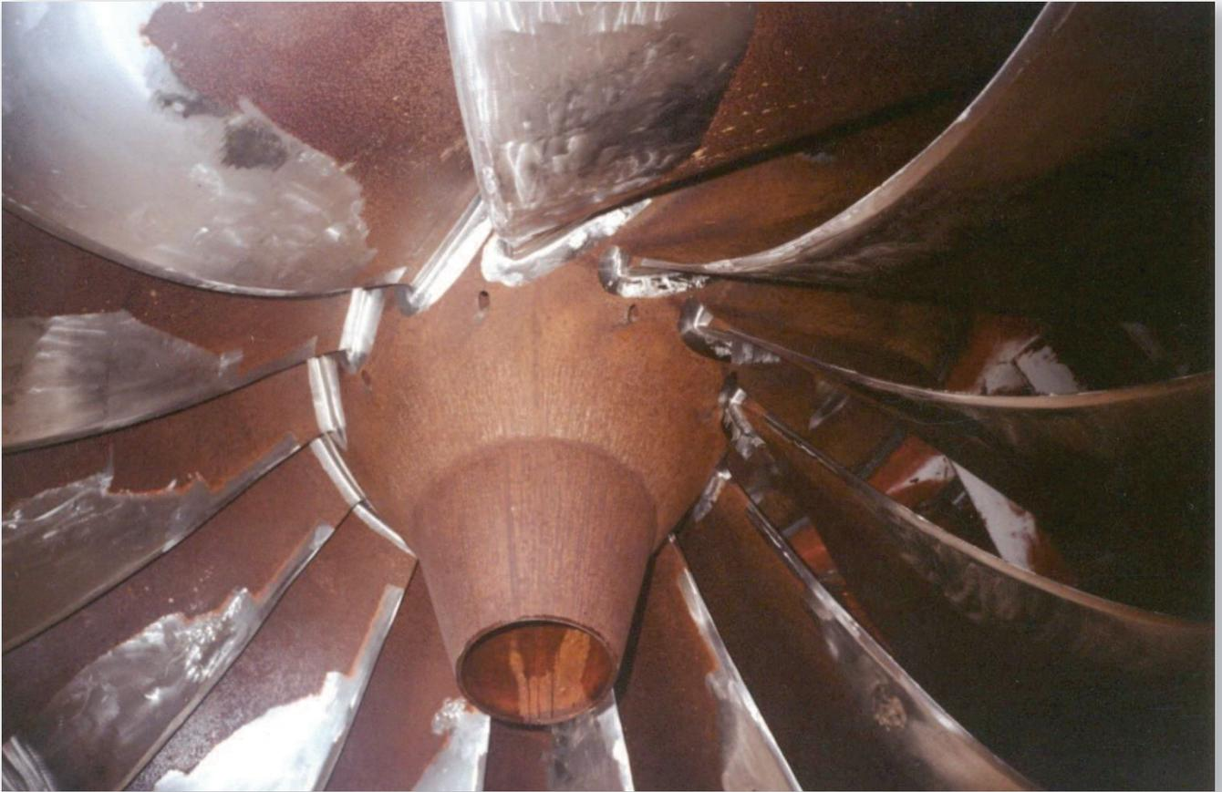
Vista desde la parte inferior de la turbina tipo Francis en proceso de mantenimiento. Gentileza Hidroeléctrica Alicurá S. A.
