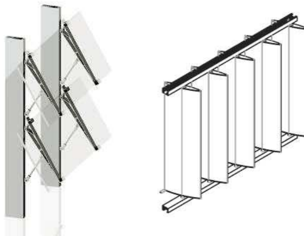
Figura 5-16: Detalle de parasoles verticales.
