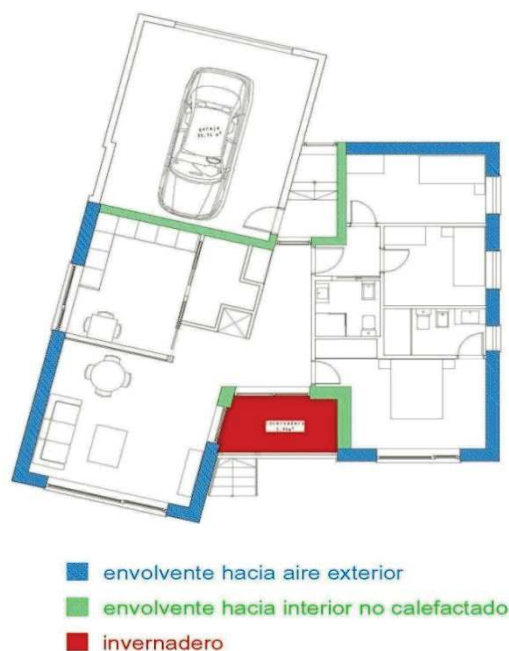
Figura 5-39: Ejemplo de cálculo de Transmitancia Térmica y su influencia en las pérdidas por transmisión en el período de invierno.
