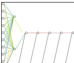
En la figura se puede apreciar la topología de la red adoptada en este caso, con 9 variables de entrada y una variable de salida. Hay 5 niveles intermedios, el primero de ellos tiene 2 nodos y los demás tienen un nodo cada uno. Los colores de las líneas que unen nodos sucesivos están en función de la magnitud del coeficiente para trasladar los valores a través de la red.
