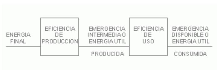
En la primera etapa, se cubre solo la eficiencia de producción de energía mecánica o energía motriz. En las etapas siguientes, se tienen cuenta las eficiencias de uso de los vehículos de transporte.
