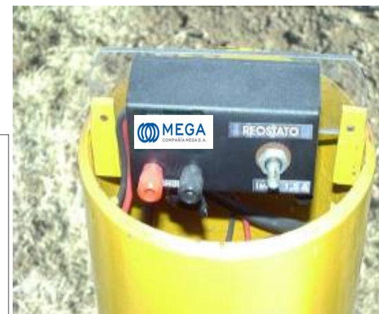
REÓSTATO PARA REGULACIÓN DE ENTRADA DE CORRIENTE
